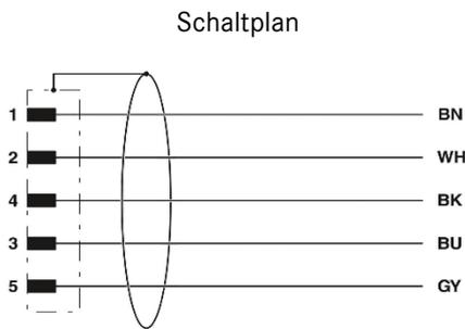
Kontaktbelegung des M12-Steckers
