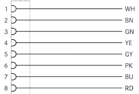
Kontaktbelegung der M12-Buchse
